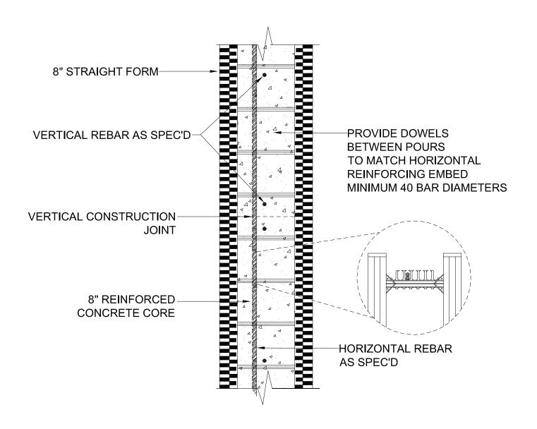
VERTICAL CONSTRUCTION JOINT
